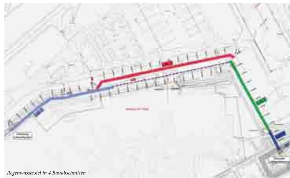
Regenwassersiel in 4 Bauabschnitten
